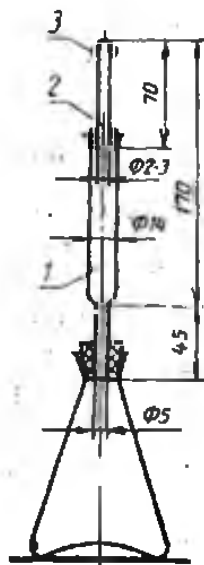
1 — стеклянная трубка диаметром 14 мм, запаянная ватой или бумагой, пропитанной раствором уксуснокислого свинца, и оставленная в пробку; 2 — стеклянная трубка диаметром 2—3 мм, на верхний конец которой помещен кружок бромнортутной бумаги диаметром 10 мм, затем кружок фильтровальной бумаги диаметром 10—20 мм и плотно прижато резиновым кольцом; 3 — две латинки, навешивающихся друг на друга и выполненные из органического стекла
